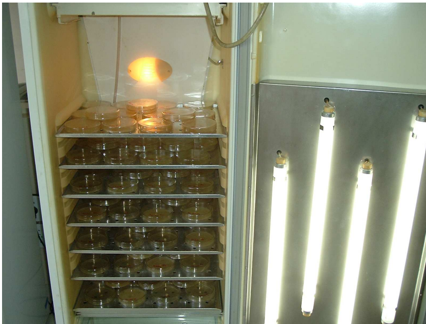
Figura 1. Vista geral das condições de incubação do Amphobotrys ricini em BOD, com controle de temperatura (25°C) e fotoperíodo de (12h claro e 12h escuro).
