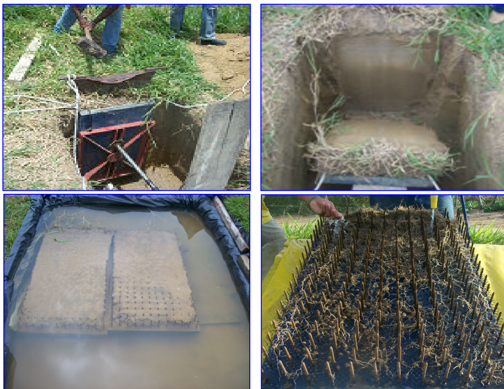
Figura 8. Esquema da seqüência realizada para determinação da massa de raiz: (a) – prancha de pregos cravada na parede da trincheira juntamente com a inserção da chapa de aço; (b) – retirada do monólito; (c) - retirada do solo para exposição das raízes por meio de água corrente e: (d) – raízes expostas após lavagem.
