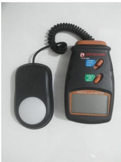
Figura 2. Luxímetro calibrado pelo Laboratório da Instrumtemp (Fonte: Acervo Insecta, 2014).
