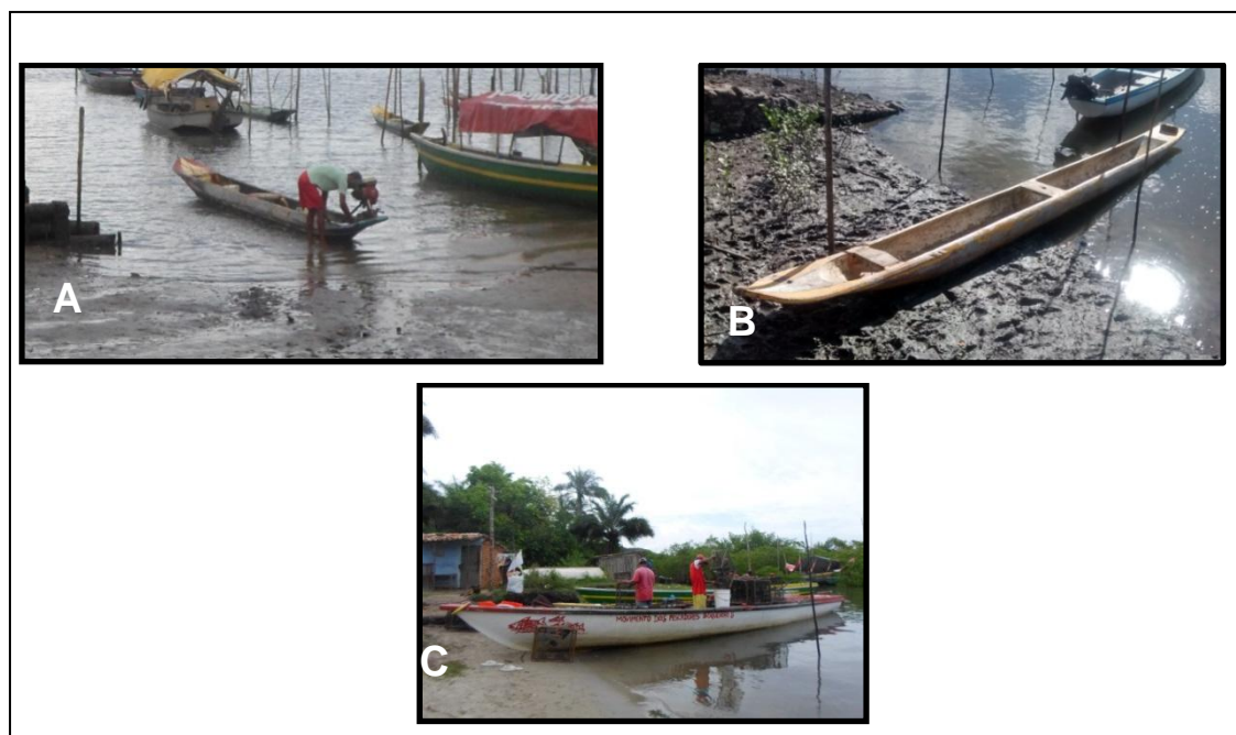
Figura 3. Embarcações envolvidas na pesca do siri: (A) Canoa madeira motor; (B) canoa remo/vela; (C) canoa fibra motor.
