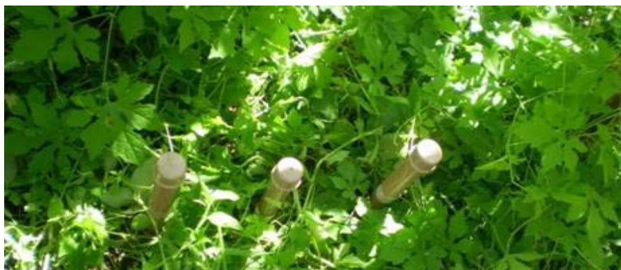
Figura 5. Tensiômetros utilizados para o monitoramento da tensão de água no solo, nas profundidades de 0,2 m, 0,4 m e 0,6 m.
