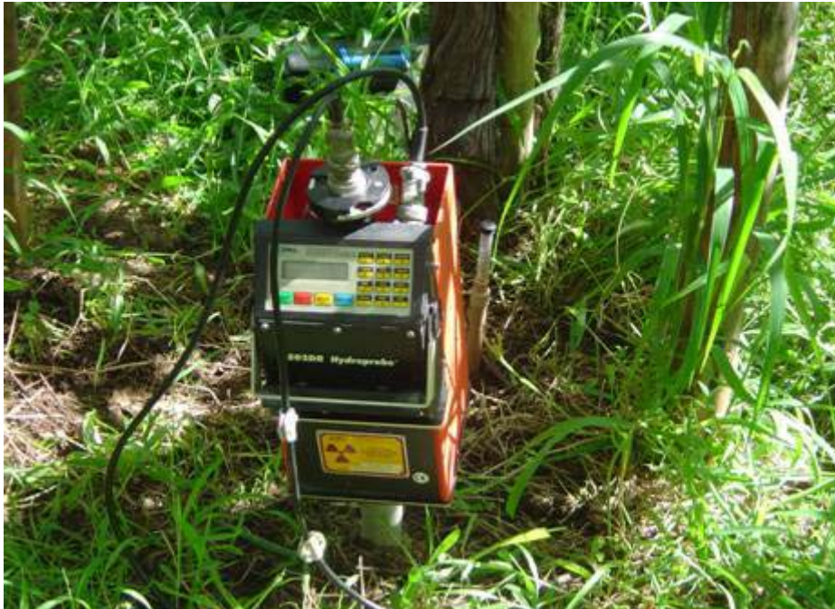
Figura 6. Sonda de nêutrons utilizada para o monitoramento da umidade do solo nas profundidades de 0,15; 0,30; 0,45; 0,60; 0,75; 0,90; 1,05 e 1,20 m.
