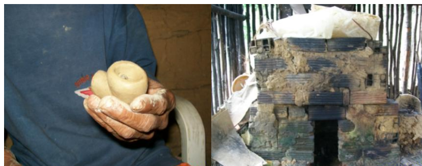
Da esquerda para direita, a peça pronta e o forno onde é realizada a queima
