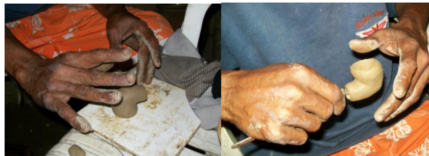
Da direita para a esquerda, Sr. Luis aplaina a peça em uma superfície e abre o canal da chaminé com a faca pontiaguda.
