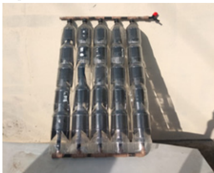
Figura 10 - Coletor de calor finalizado.
