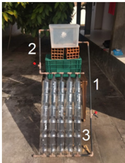
Figura 11 - Aquecedor solar finalizado.
