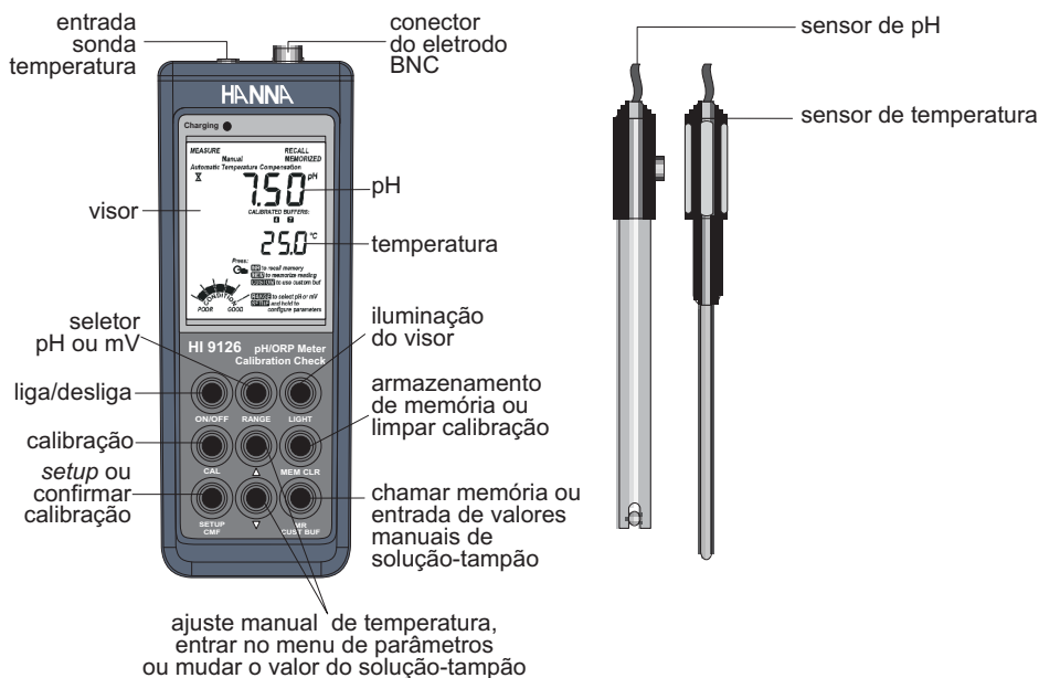
Figura 6.2 pHmetro e seus componentes [adaptado do Manual do mod. HI 9126 da Hanna Instruments ].
