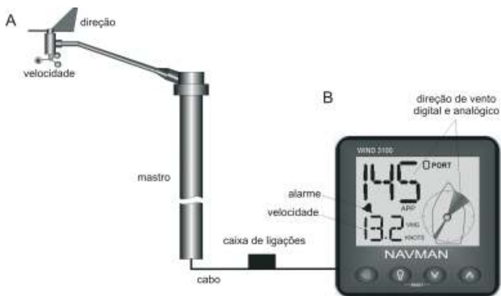
Figura 2.8 Anemômetro: (A) sensor; (B) mostrador [adaptado do Manual de Operação do Modelo WIND 3100 da NAVMAN].
