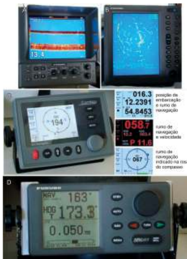
Figura 4.8 Instrumentos de navegação instalados no N/Pq Atlântico Sul: (A) ecossonda; (B) radar; (C) GPS, onde são apresentadas os três tipos de informações fornecidas pelo equipamento; (D) piloto automático [Fotos: Danilo Calazans].
