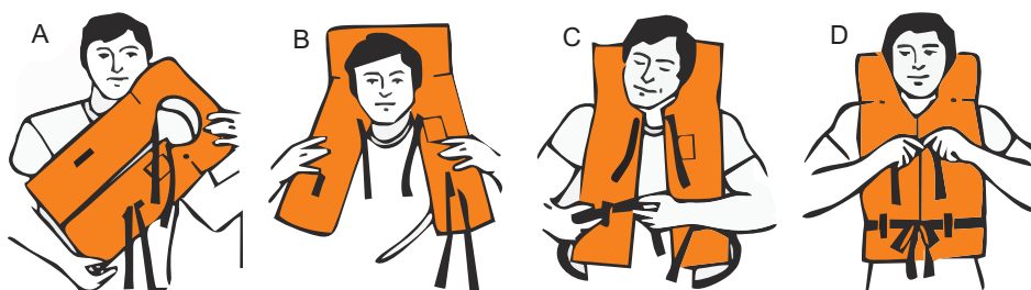
Figura 3.1 Instruções para colocação do colete salva-vidas: (A) desamarrar os cintos, deixando-os livres; (B) separar os gomos e enfiar a cabeça entre os mesmos, puxando para baixo até senti-los acomodados à nuca; (C) passar a parte solta do cinto inferior por trás das costas e atravessar pelo passador; (D) amarrar os cintos, primeiro o inferior e depois o superior, pressionando até os gomos se encontrarem.
