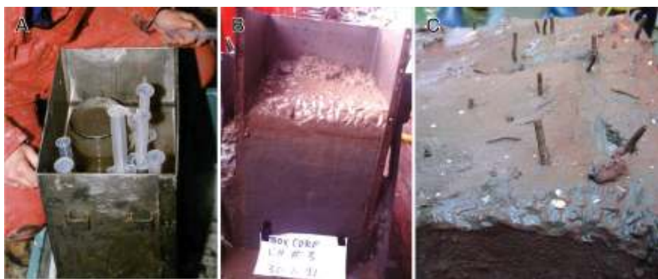
Figura 7.6 Visão da parte superior do box corer com as subamostragens [Fotos: (A) e (B) FIGUEIREDO, 2000 e (C) Gilberto Griep].
