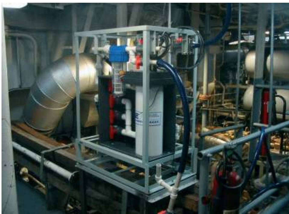
Figura 5.10 Termossalinógrafo Sea-Bird instalado na praça de máquinas do ARA Puerto Deseado durante o cruzeiro do projeto La Plata de inverno [Foto: Carlos Balestrini].
