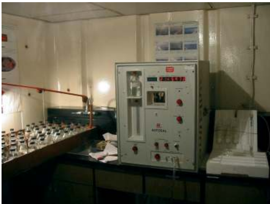
Figura 5.11 Autosol Guildline instalado no laboratório do ARA Puerto Deseado durante o cruzeiro do projeto La Plata de inverno [Foto: Carlos Balestrini].
