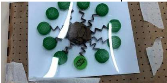
Figura 20 - Prendendo a matriz e a lâmina plástica com fita crepe
