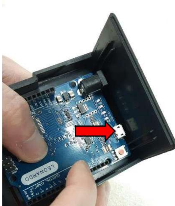
Figura 9 - Posicionamento da conexão USB próximo da lateral menor da caixa
