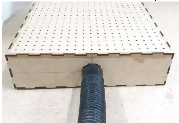
Figura 14 - Caixa termoformadora conectada ao aspirador de pó
