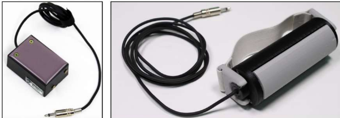
Figura 14 – Acionador de caixinha e acionador de bastão
