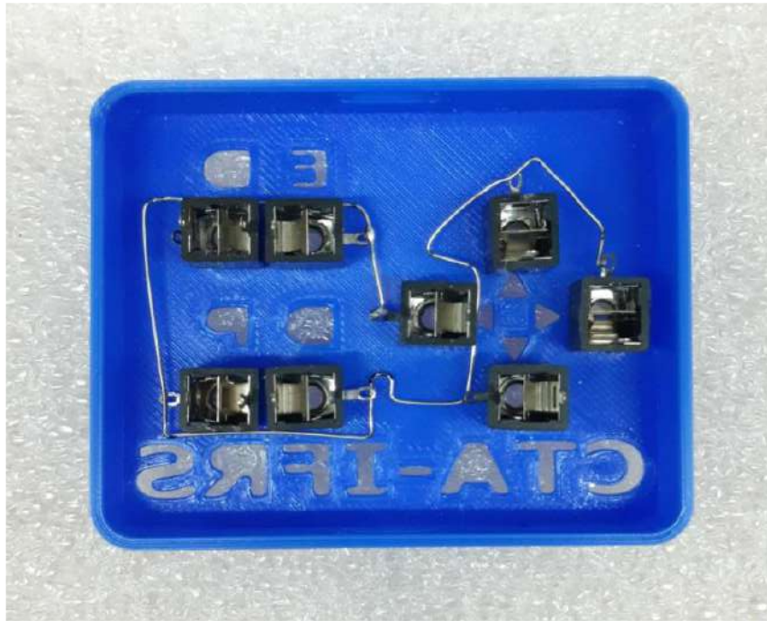
Figura 15 - Ligação dos terminais GND dos Jacks J2 com um fio rígido
