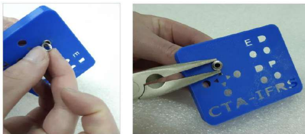
Figura 12 - Montagem dos Jacks J2 nos furos da caixa
