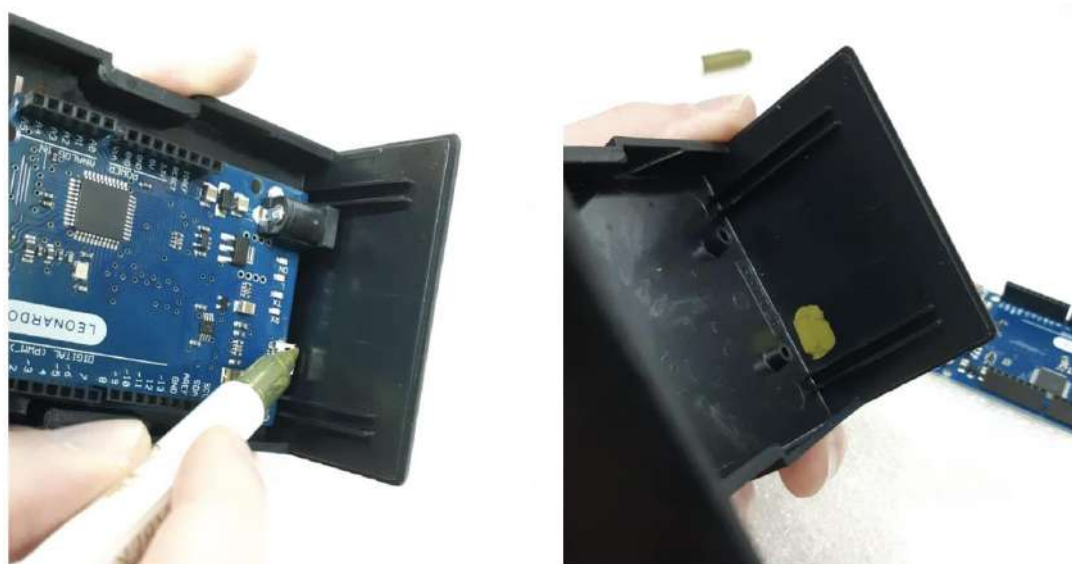
Figura 10 - Marcação do local onde o conector USB toca a lateral menor
