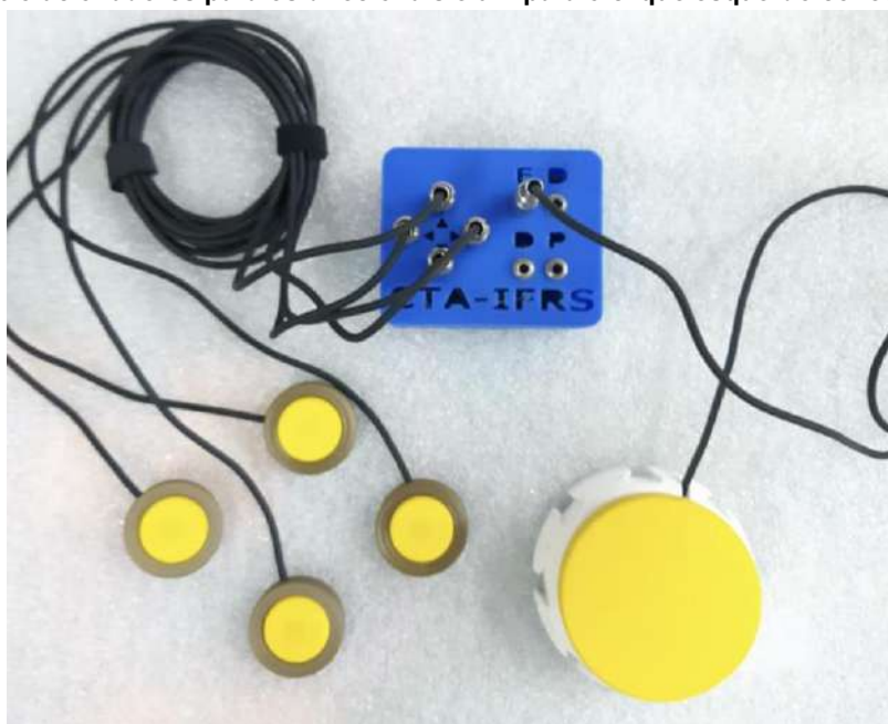
Figura 19 - Quatro acionadores para os direcionais e um para o clique esquerdo conectados ao mouse
