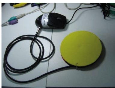
Figura 70 – Acionador desenvolvido no Núcleo de Atendimento às Pessoas com Necessidades Especiais Fonte: Cainelli (2011)
