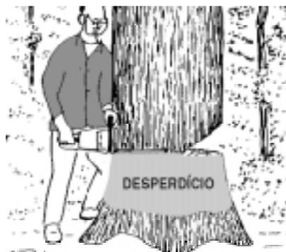
Figura 11. Erro na altura do corte.
