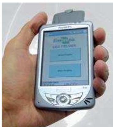
**Geo Fielder** é uma solução para coleta geo-referenciada de dados e imagens. Utiliza software para computadores de mão (PDAs), câmeras e GPS acoplados.
